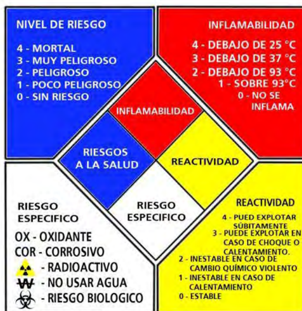
Fig. 3. Etiquetado de productos químicos
