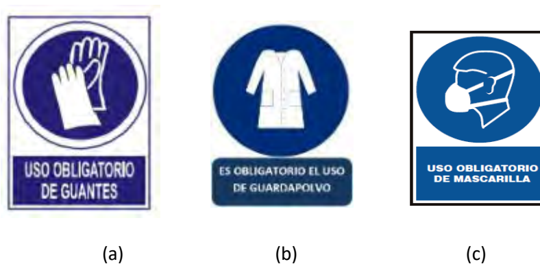
Fig. 2 (a) uso obligatorio de Guantes; (b) uso obligatorio de guardapolvo. Señales de obligación usadas en el laboratorio; (c) uso obligatorio de mascarilla.
